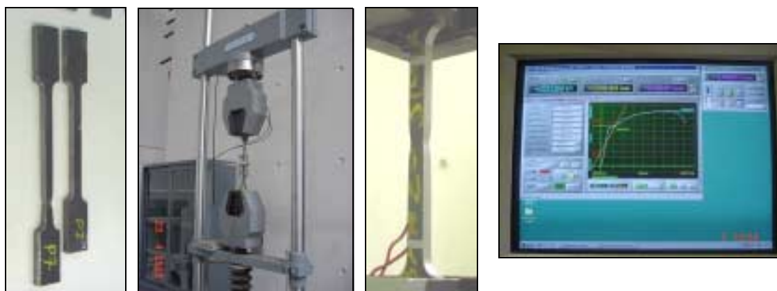
Figura 3.3 – Corpo de prova, máquina de ensaio, estrição
